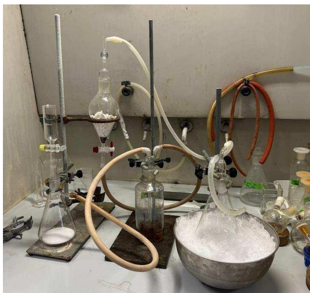
Figura 3.1: Montagem para preparação de ácido clorídrico etéreo 3M.
