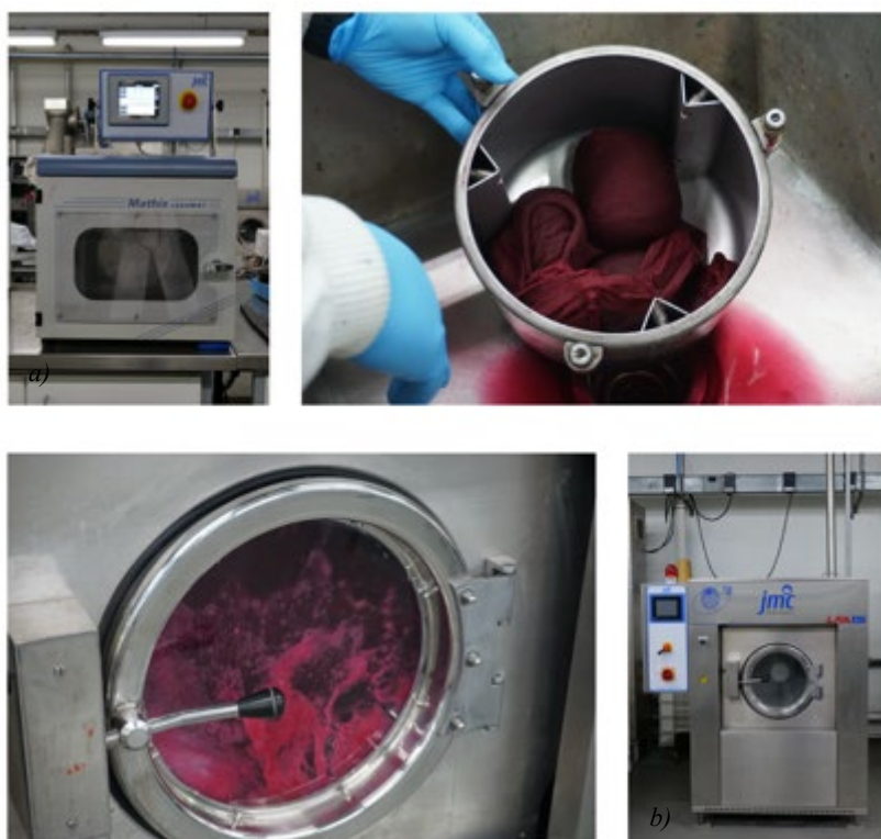
Figura 19 - Equipamento e processo de tingimento. a) Máquina Mathis Labomat; b) Máquina Máquina de Lavar de Alta Centrifugação
