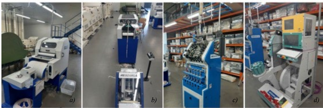
Figura 27 - Equipamentos da linha laboratorial de fiação do CITEVE: (a) carda, (b) laminador/torce, (c) contínuo de fiação, (d) bobinadeira
