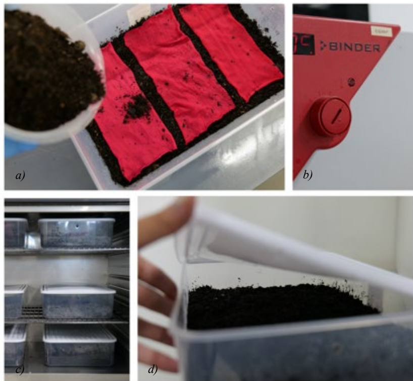
Figura 25 - a) Enterramento; b) Estufa Binder; c) Interior da estufa com os reatores; d) Reator com os provetes enterrados.
