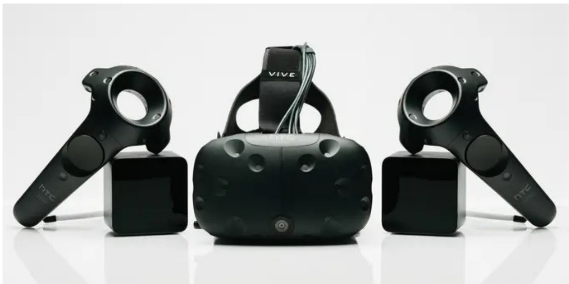
Figura 3.2: HTC Vive headset , emissores laser infravermelho e comandos.(Fonte:Virtual Reality (VR) - Explained Simply[6])
