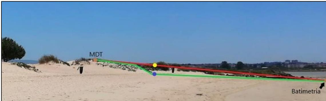
Figura 3-14 - Representação Esquemática do Problema de Coerência entre o MDT e a Batimetria
