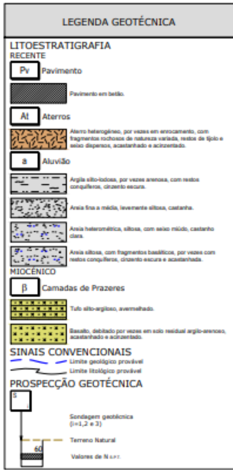
Figura 4.8 – Legenda do perfil geológico e geotécnico da Alcântara Lote 9 (Geocontrol, 2019).
