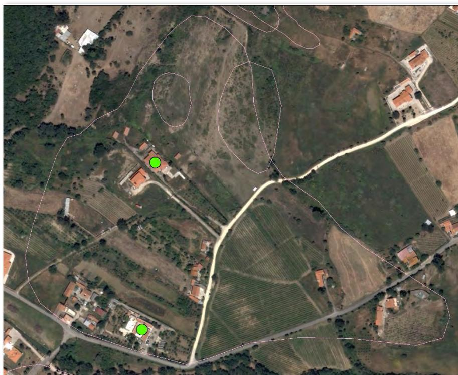
*Figura 4.3.1. – Exemplo de dois edifícios residenciais construídos entre 1995 e 2011 sobre um antigo deslizamento rotacional profundo, desencadeado em 1989.*
