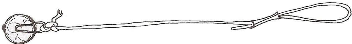
4. Prende ao clipe uma anilha metálica (ou moeda de 1 cêntimo), e terás o pêndulo construído.
