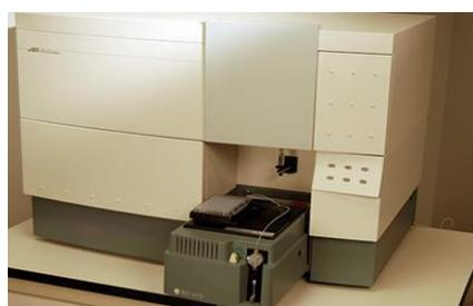
Figura 11: Citómetro de fluxo *FACSCalibur* da *BD DIAGNOSTICS*.
