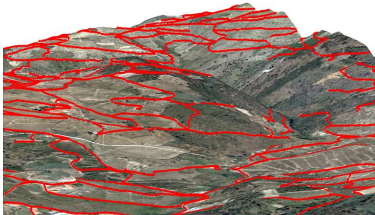
Figura 4.5 – Visualização no ArcScene da informação das vias de comunicação com altimetria extraída do MDT Fonte: Autor
