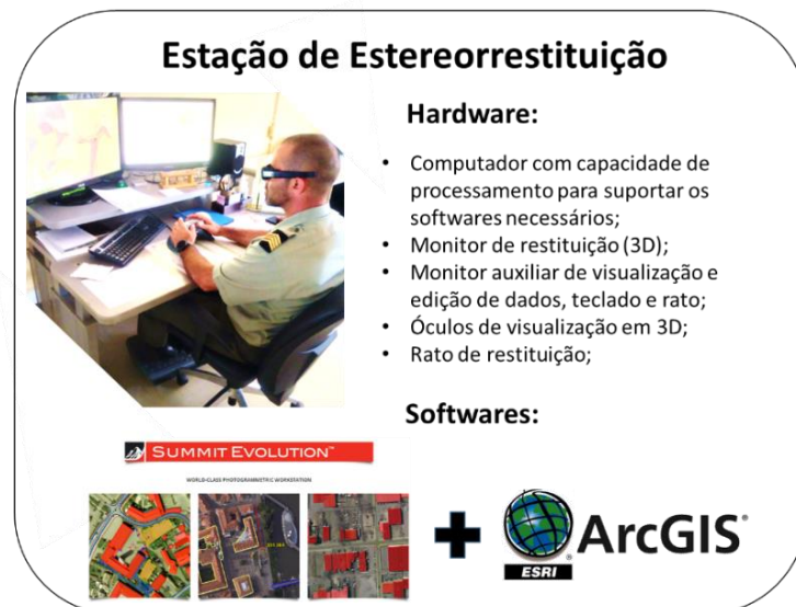
Figura 3.4 – Principais constituintes (hardware e software) de uma estação fotogramétrica Fonte: Autor
