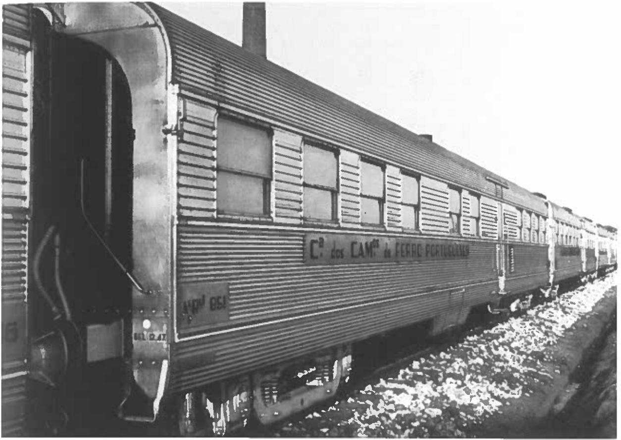
1941 CP – Carruagens da “CP” de concepção tubular, em aço inoxidável, fabricadas pela empresa americana “Budd” (Gilberto Gomes (coord.), O Caminho de Ferro Revisitado , Lisboa: Caminhos de Ferro Portugueses, 1996).
