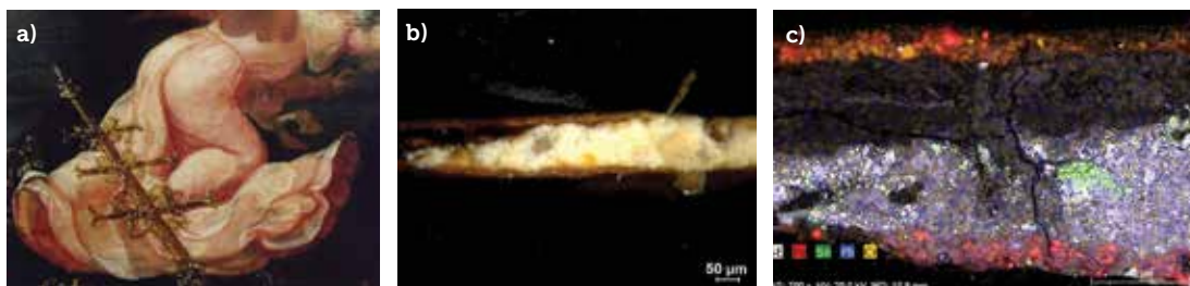
Figura 17 - a) Representação do báculo dourado do Papa; b) Imagem de MO da amostra 45-15-31 mostrando uma primeira camada castanha sobre a preparação sobreposta por uma camada branca/amarela; c) Mapa combinado de análise elementar por SEM-EDS da mesma amostra com os elementos Fe, Sn, Pb e Cr, onde Fe surge como uma primeira camada, Pb indica a presença de branco de chumbo e Sn-Pb sugerindo a ocorrência de amarelo de estanho e chumbo, sendo a camada superior de Crômio (Cr) um repinte.
