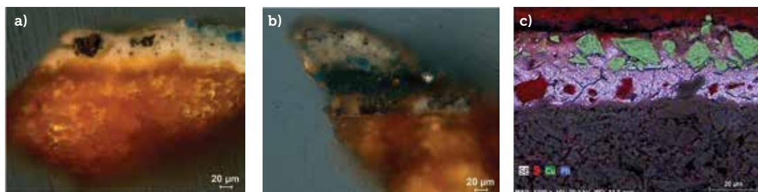
Figura 9 - a) Imagem de MO da amostra 45-15-4 da zona de luz do céu mostrando uma primeira camada branca sobre a preparação, sobreposta por uma azul clara; b) Imagem de MO da amostra 45-15-5, sombra do céu, mostrando uma primeira camada branca sobre a preparação sobreposta por uma camada azul escura; c) Mapeamento de SEM-EDS da mesma amostra obtida para C, Cu e Pb, onde C sugere a presença de carvão animal, Pb sugere a presença de branco de chumbo e Cu a ocorrência de azurite.
