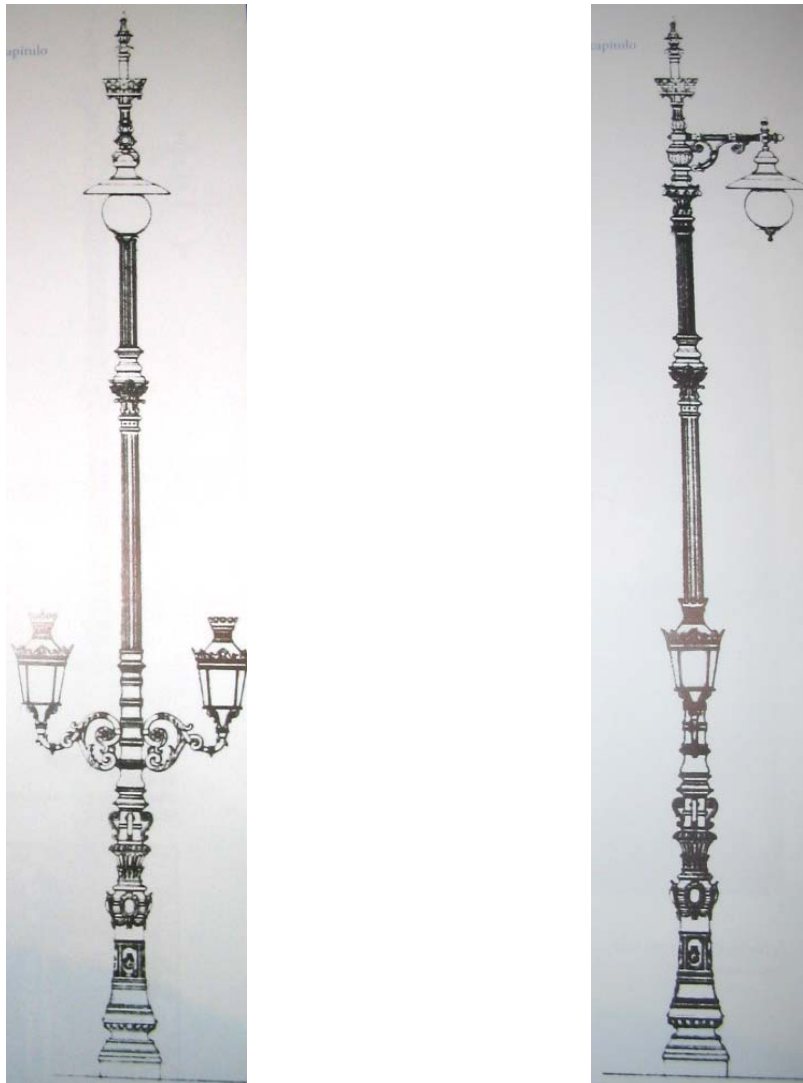
Figura 20 : Os híbridos da Avenida - gás e electricidade num só candeeiro
