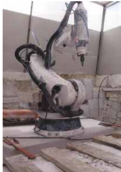
Fig.124. Máquina de esculpir robótica de corte vertical e horizontal controlada por computador (sem base rotativa). TorArt Studio, Carrara, Itália.
