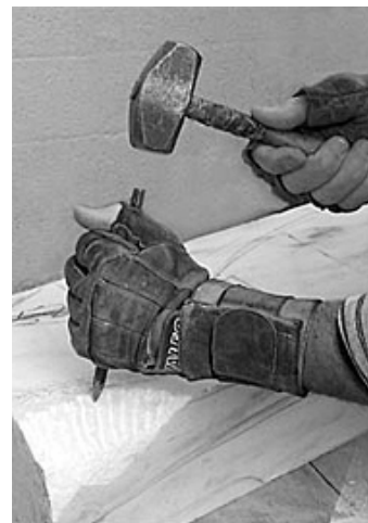
Fig.64. Desbaste manual com ponteiro e martelo.
