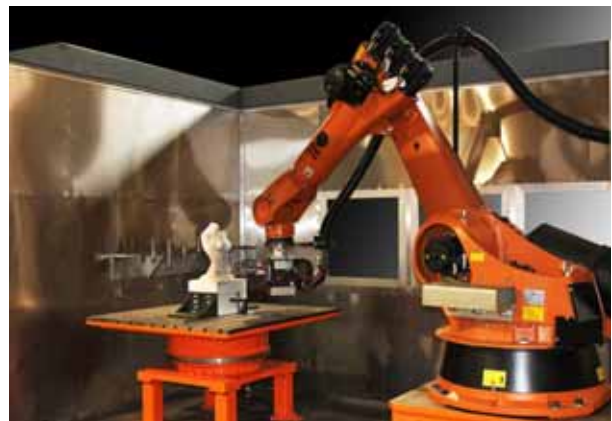
Fig.125. Máquina de esculpir robótica de corte vertical e horizontal controlada por computador (com base rotativa).
