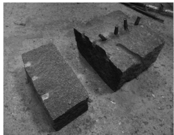
Fig.60. Divisão de um bloco de basalto com cunhas Mamaya japonesas.
