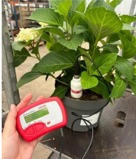
Figura 27: Medição da humidade do substrato.
