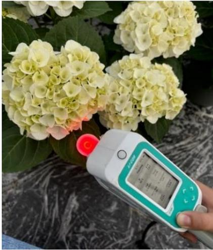
*Figura 19: Medição com o porômetro da fluorescência e condutância estomática das folhas.*
