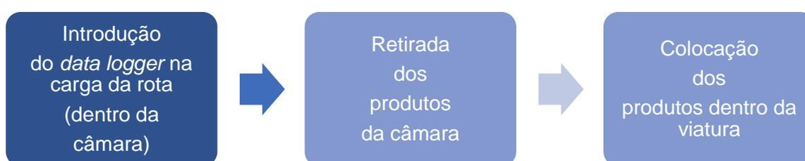
Figura 4 - Processo do estudo da variação de temperatura dos produtos.
