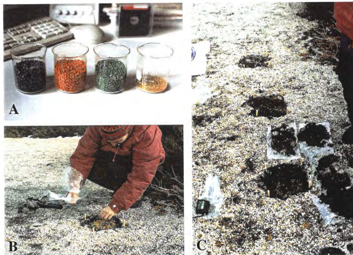
Figura 9.7 – Aspectos da instalação da experiência de monitorização da crioexpulsão com grânulos pintados na Fraga das Penas em Dezembro de 1997. A – Grânulos pintados segundo diferentes classes granulométricas; B – Instalação dos grânulos a 2 cm de profundidade, após remoção de película superficial; C – Aspecto da instalação dos grânulos a diferentes profundidades, lado a lado (cada local de enterramento está limitado por estacas de madeira).
