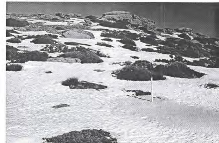
Figura 9.45 – Tubo para monitorização da corrasão nivo-eólica instalado no Cântaro Raso. Ambos os tubos neste local foram vandalizados.
