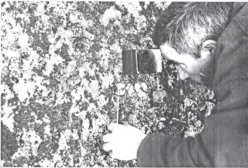
Figura 10.8 – Instalação do sistema de monitorização das temperaturas da rocha na vertente norte do Cântaro Gordo.
