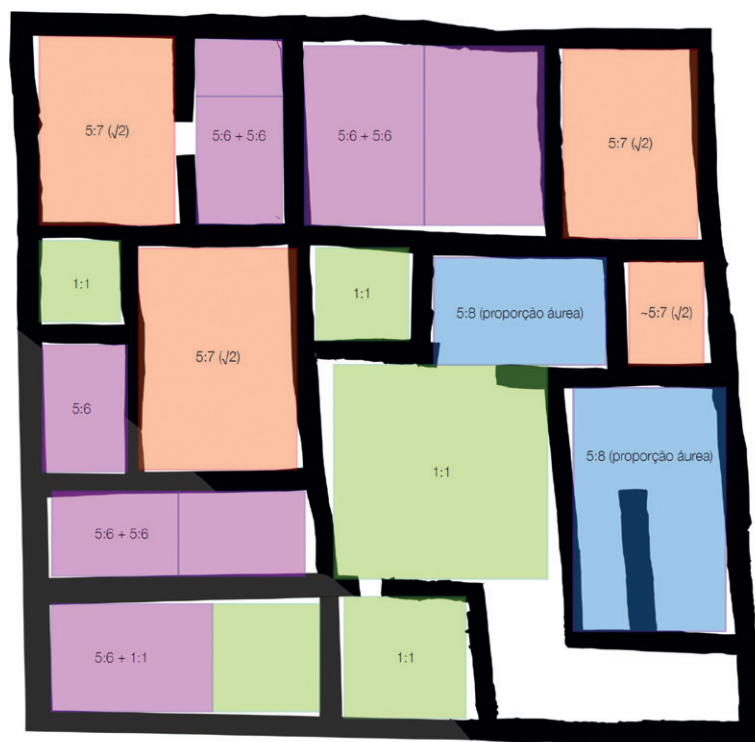
I.172 – Análise das proporções patentes nos diferentes Ambientes da casa da Sondagem 4.
