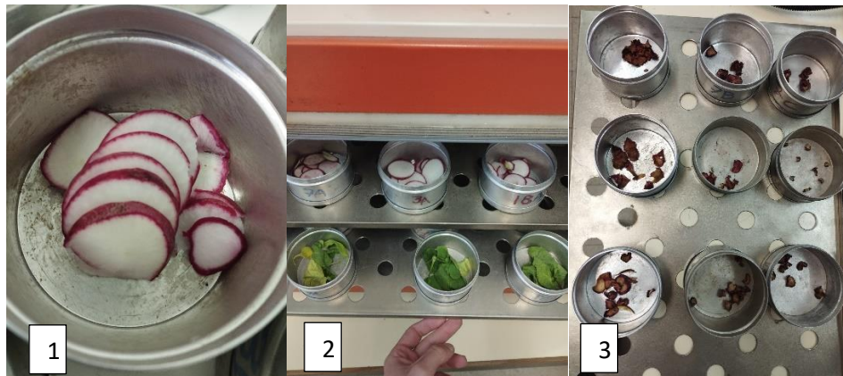
Figura 3.13 – Preparação após pesagem (1), colocação em estufa de secagem (2) e matéria seca após secagem (3) de rabanetes.
