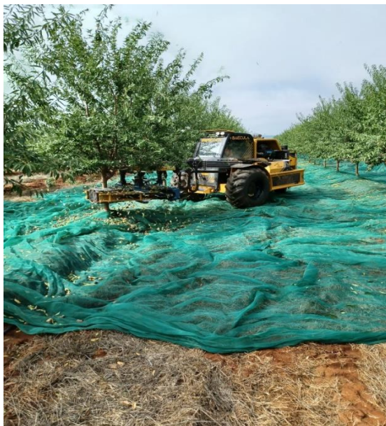
Figura 21 - Máquina vibradora Videlsur utilizada na colheita da amêndoa, em sistema intensivo.
