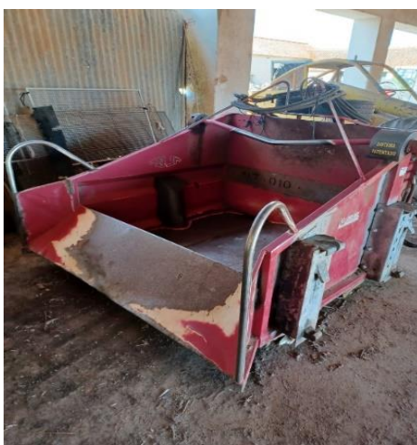
Figura 22 - Cx Recolhedora Panos 2 JD utilizada para a recolha dos panos utilizados na colheita da amêndoa.
