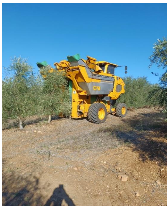
Figura 20 - Gregoire G9 na colheita da azeitona. Esta mesma máquina foi responsável pela colheita da amêndoa no sistema superintensivo
