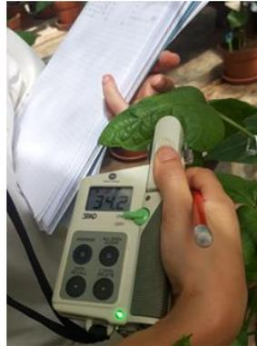
**Figura 13 - Determinação e leitura do teor relativo de SPAD com o equipamento SPAD-502 Plus, Konica-Minolta. (Fotografia do autor)**
