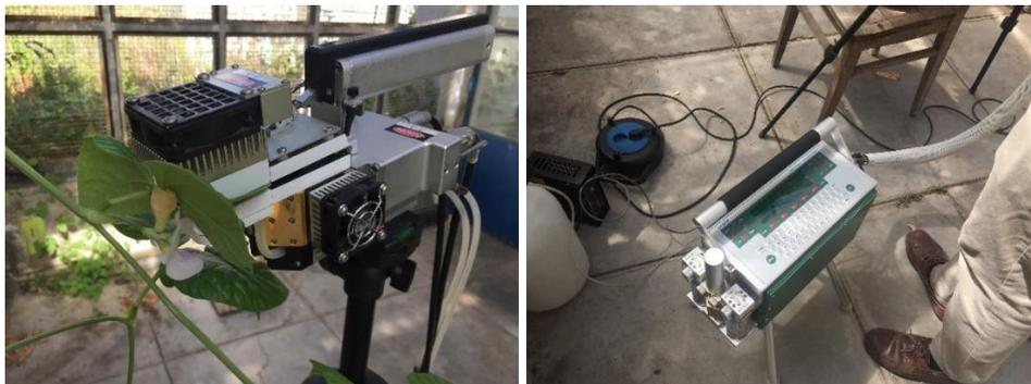
**Figura 12 - Determinações com o analisador portátil de gases ( $\text{CO}_2/\text{H}_2\text{O}$ ) por infravermelho - IRGA – Infra Red Gas Analyser - Li-Cor 6400. (Fotografias do autor)**
