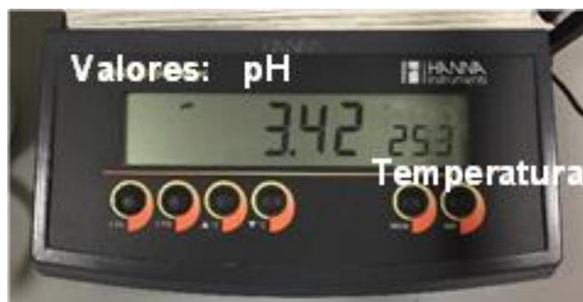
Figura 9 - Mostrador do medidor de bancada da marca *HANNA instruments* do modelo pH2110 com valores exemplo de pH e de temperatura.
