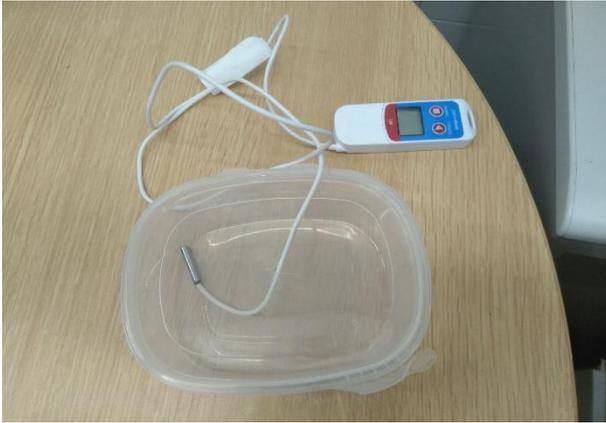
**Figura nº3**-Caixa de empratamento/embalamento com *logger* inserido (Fonte: Própria)
