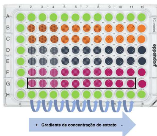
Figura 9 – Esquema ilustrativo da microplaca utilizada no ensaio para a determinação das CMI e CMB.
