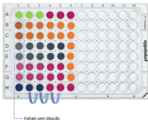
Figura 11– Esquema ilustrativo da microplaca utilizada no ensaio para determinação da CMEB.
