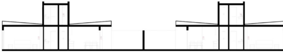
73. Corte longitudinal da agregação na fase inicial. Relevância para as coberturas leves de zinco, que na fase posterior facilmente são removidas e re-usadas. Os pátios são separados por muro, podendo este ser opcional, caso os moradores pretendam.
