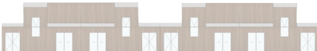
76. Alçado principal da agregação na fase inicial. Janelas de sacada para garantir maior entrada de luz natural, bem como uma segunda entrada. No núcleo de escadas, metade da janela é vidro fixo a outra metade oscilobatente.
