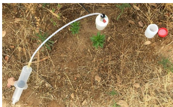
Figura 11 Extração de amostra através de um tubo e seringa.
