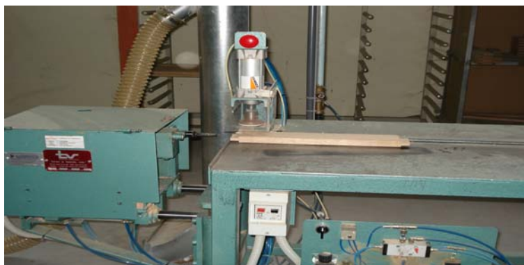
Figura 44 – “Furação” de travessas
