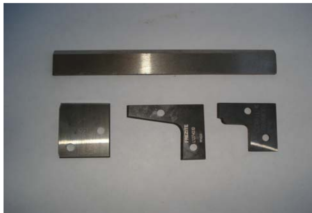
Figura 29 - Pastilhas de metal duro utilizadas no fresamento de perfil e no aplainamento. Fonte: Frezite ferramentas.
