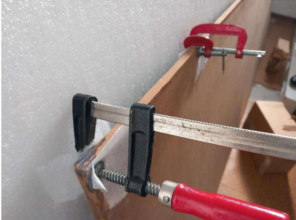
Imagem 72: Colagem de painel cenográfico com Plextol B-500® com auxílio de grampos (©Carlota Silva, 2024)
