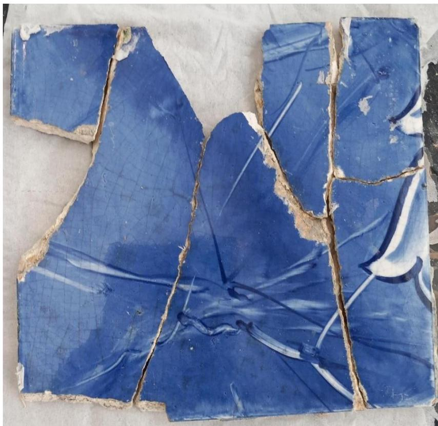
Imagem 34: Azulejo 219 – Montagem do azulejo e detecção de falta de três fragmentos (©Carlota Silva, 2024)
