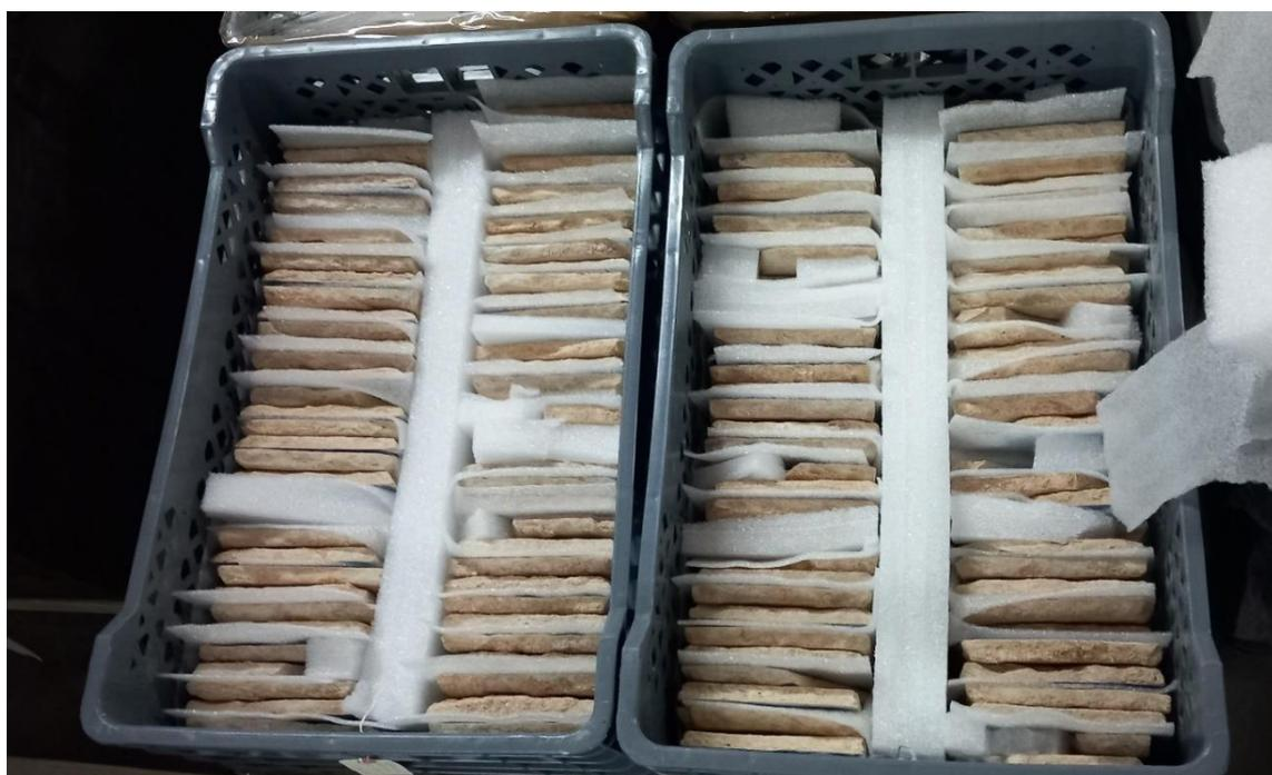
Imagem 8: Segunda fase do acondicionamento – Colocar polietileno de espuma de diferentes espessuras entre as duas filas de azulejos e nas zonas de lacuna (©Carlota Silva, 2023)
