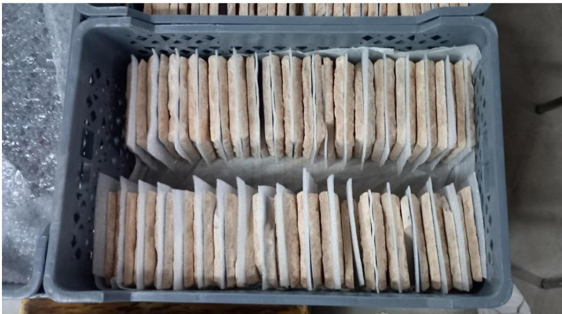
Imagem 7: Primeira fase do acondicionamento –Forrar o contentor com polietileno de espessura fina, colocar os azulejos por ordem alfanumérica e adicionar polietileno de espessura fina entre os vidrados dos azulejos (©Carlota Silva, 2023)
