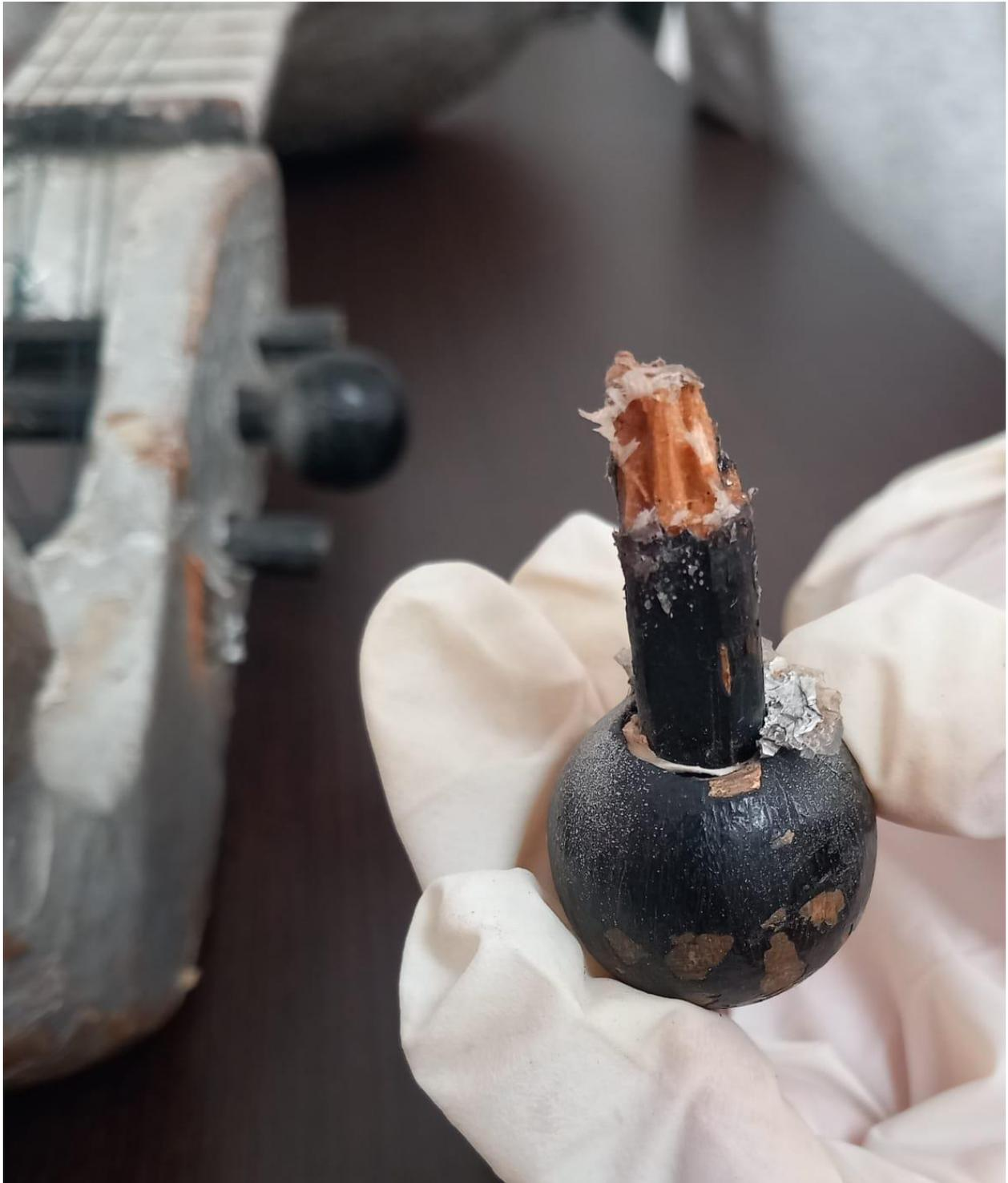
Fotografia 5: Tarraxa fraturada em duas partes
