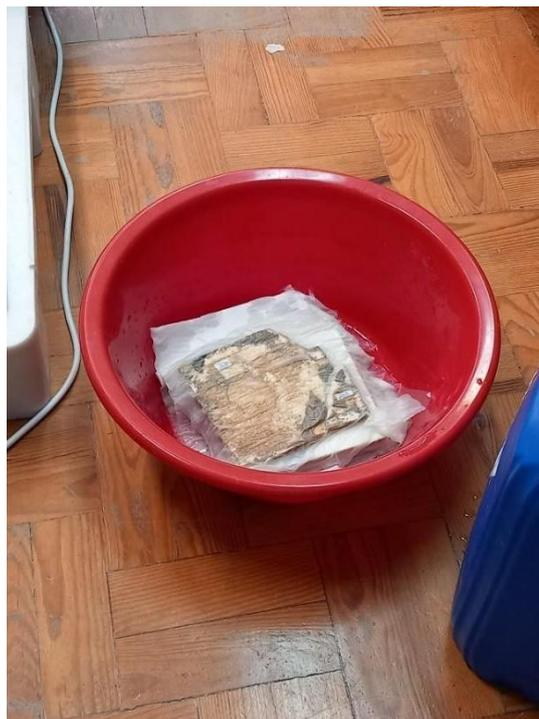
Imagens 26 e 27: Preparação para limpeza química dos azulejos dos BVS com água oxigenada a 130 Vol. (©Calota Silva, 2024)
