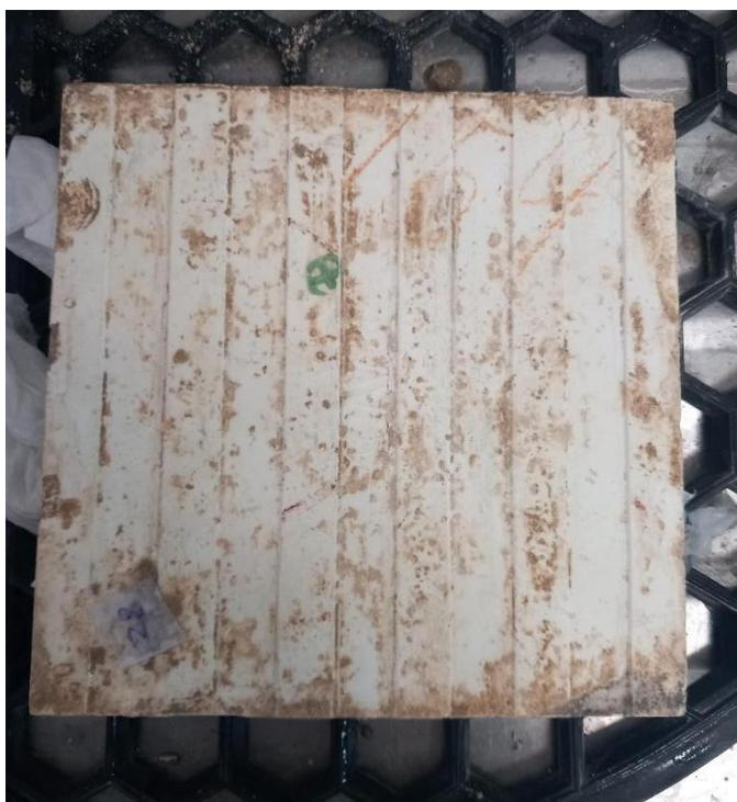
Imagem 23: Azulejo 28: Após a limpeza mecânica com escovas e bisturi (Na zona central é perceptível a marca verde da fábrica) (©Carlota Silva, 2024)
