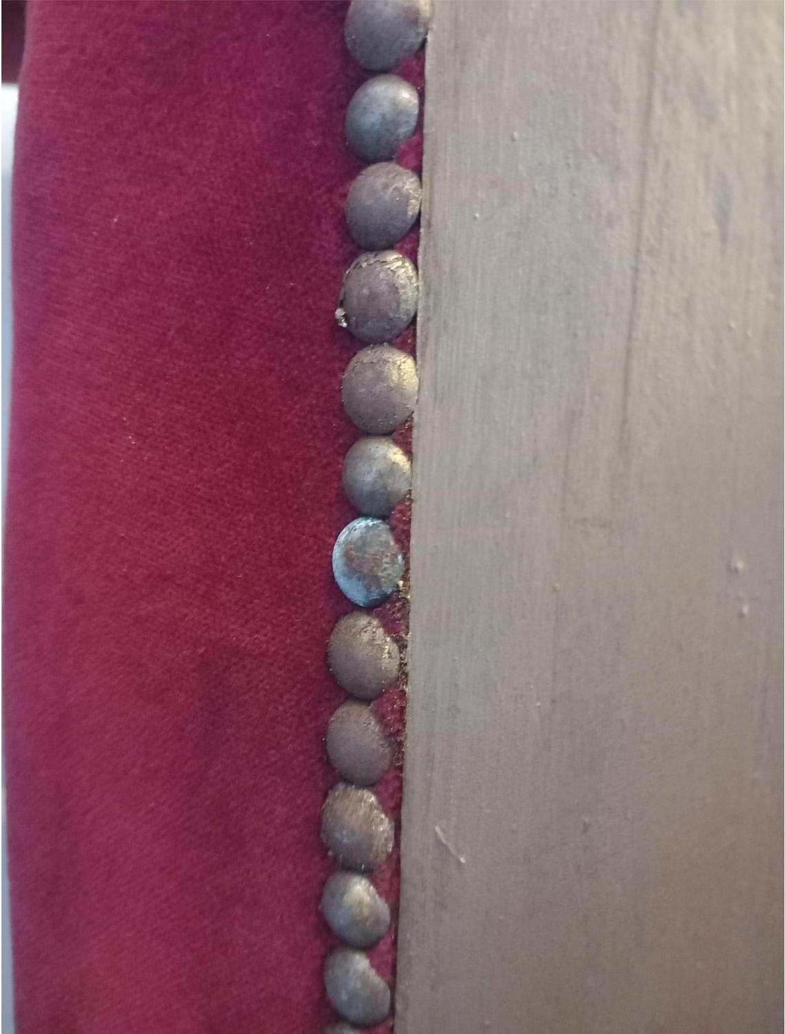
Fotografia 8 – Elementos metálicos oxidados (tachas metálicas)
