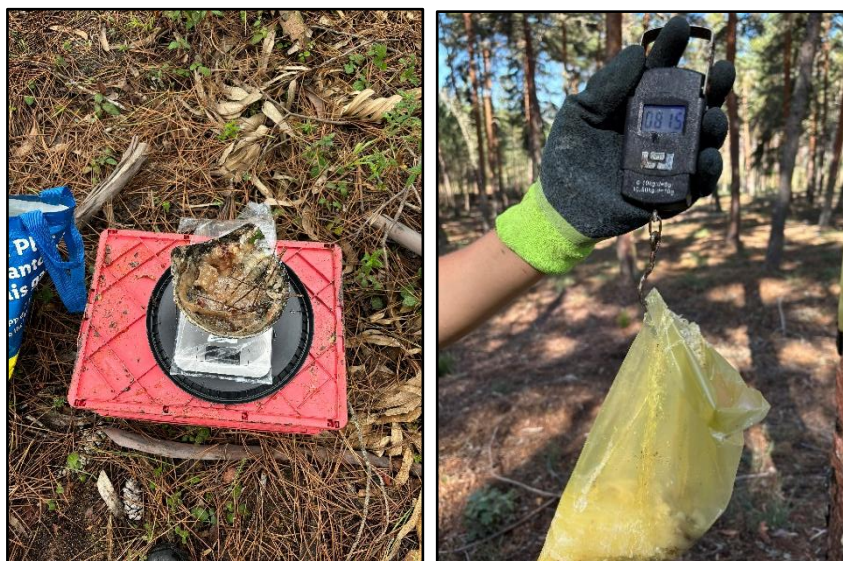
Figura 18 – Métodos de pesagem de resina em campo.
