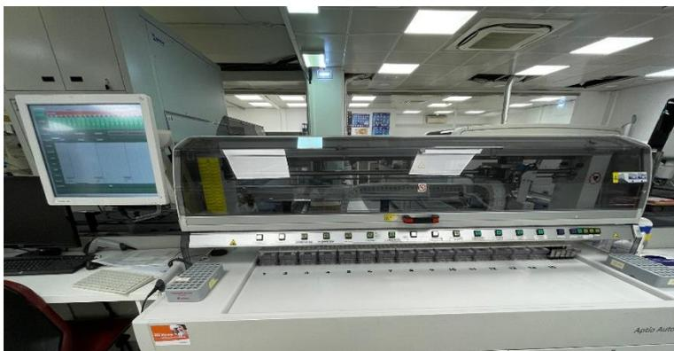
**Figura 1.** Módulo de entrada e saída de amostras (IOM) do sistema *Aptio® Automation da Siemens Healthineers*.
