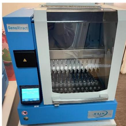
**Figura 43.** Equipamento automático de extração de ácidos nucleicos GenoXtract® da Hain
