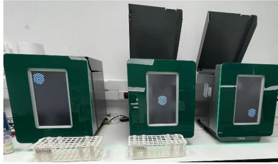
**Figura 19.** Analisador automático Ves-Matic Cube 30 Touch.
