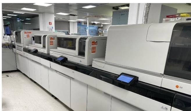
**Figura 3.** Linha de aparelhos Atellica® composta por dois aparelhos CH930 e um aparelho IM1600.
