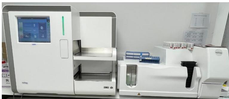
**Figura 17.** Analisador automático Yumizen H1500 com sistema Yumizen SPS.
